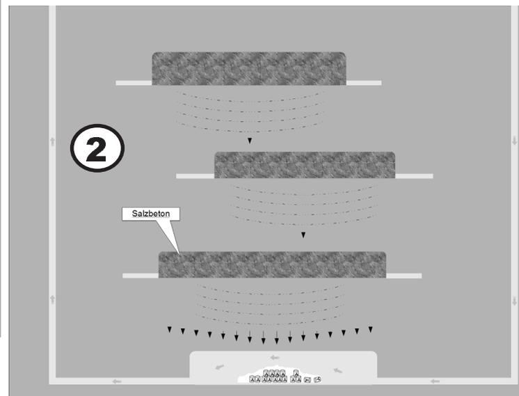
Seit 2003 wurde in den Hohlräumen über der Kammer sogenannter „Salzbeton“, eine Mischung aus Salzgrus, Zement und anderen Zusatzstoffen eingebracht. Eigentlich zur Stabilisierung des einsturzgefährdeten Endlagers. Allerdings lastet nun das Gewicht der insgesamt fast 800.000 Kubikmeter Salzbeton auf den offen gelassenen Hohlräumen. Dies wurde schon zu Beginn dieser vom Bundesamt für Strahlenschutz veranlassenen Maßnahme kritisiert, angeblich sei dies aber kein Problem.
